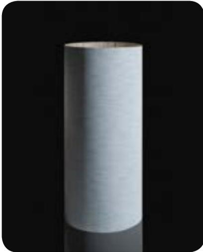
ЕКА 3001 N используется в случаях, когда качество поверхности более важно, чем величина снятия поверхности шлифовкой. Карбид кремния в сочетании с бумагой типа Е позволяет эффективно шлифовать лакированную поверхность. ЕКА 3001 N дополнительно обработана улучшенным стеаратом, который эффективно предотвращает забивание ленты и дает замечательную конечную обработку.
